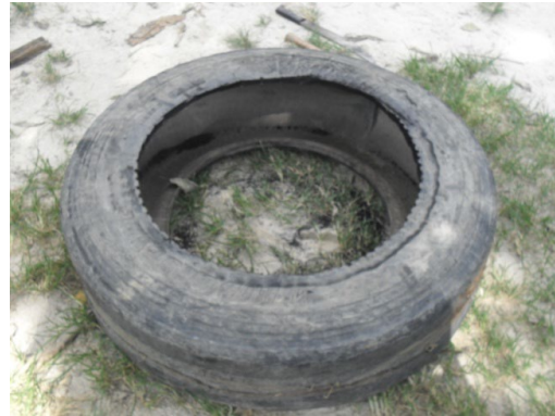
Ilustración 12 Corte del neumático a 3.5" del aro interior.
