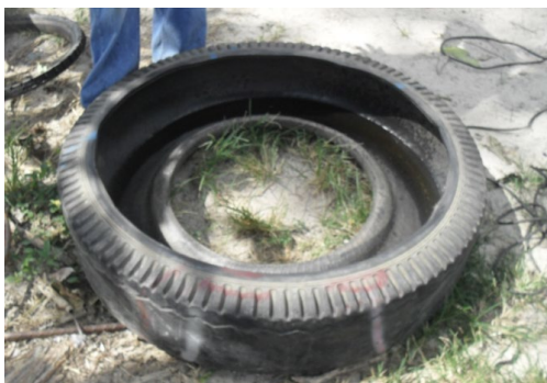
Imagen 29 Corte de 7 pulgadas de aro interior.
