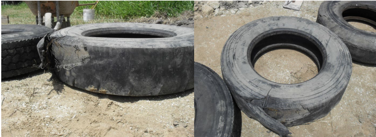
Imagen 26 Desgaste orientado hacia área interior
