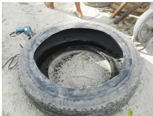
Imagen 28 Corte de 3 pulgadas de aro interior.
