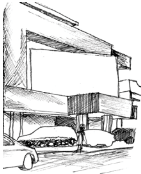
Figura 97. Voladizo en fachada
