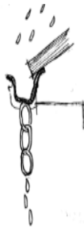
Figura 114. Cadena conducción aguas lluvias
