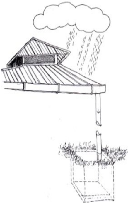
Figura 128. Captación de aguas lluvias
