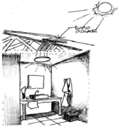
Figura 29. Vista interior ducto solar
