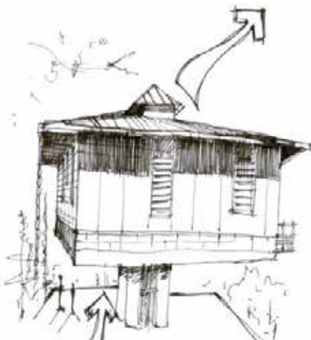
Figura 120. Ventilación por el piso.
