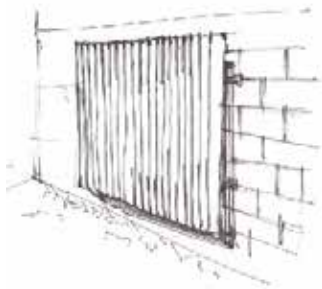
Figura 75. Pantallas de sombreado de paredes
